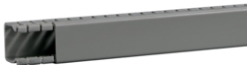
BA6, bedradingskanaal + deksel zonder bodemperforatie 30x25mm, grijs
